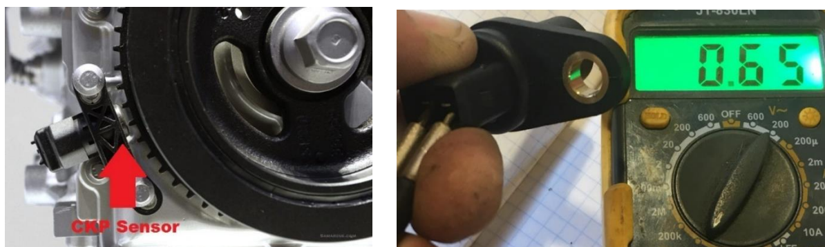
Рисунок 2 - Измерение сопротивления между контактами 1 и 2 разъема датчика положения коленвала [3,5]
