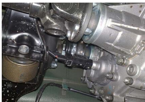
Рисунок 5 – Замер выходного напряжения датчика скорости [3,4]
