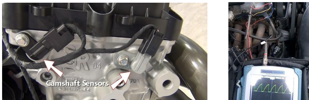
Рисунок 8 – Проверка датчик положения распредвала с помощью осциллографа [3,4]
