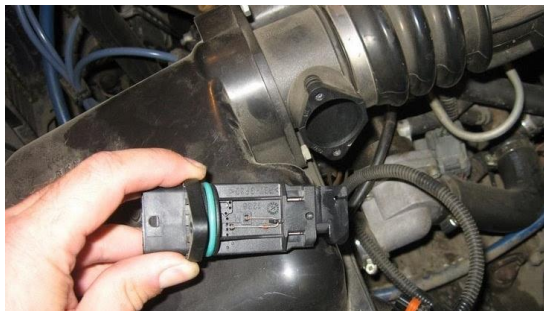
Рисунок 6 – Измерение выходного напряжения датчика массового расхода воздуха [3,4]
