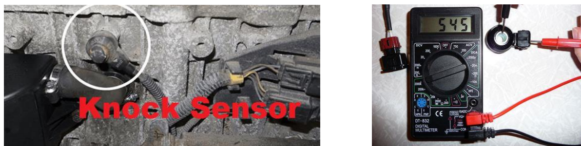
Рисунок 3 – Измерение сопротивления датчика детонации [3,6]
