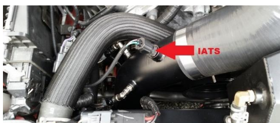
Рисунок 4 – Измерение сопротивления датчика температуры всасываемого воздуха [3,4]
