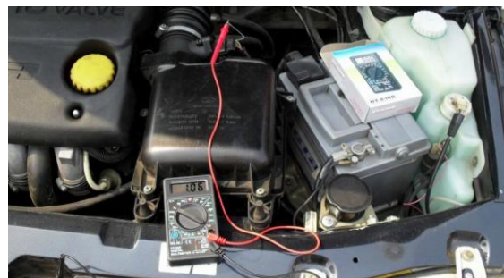
Рисунок 6 – Измерение выходного напряжения датчика массового расхода воздуха [3,4]
