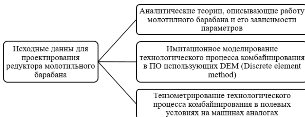
Рисунок 1 – Схема получения исходных данных для проектирования редуктора молотильного барабана.
