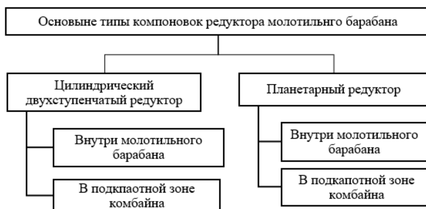
Рисунок 2 – структурная схема основных типов компоновок приводов молотильного барабана.
