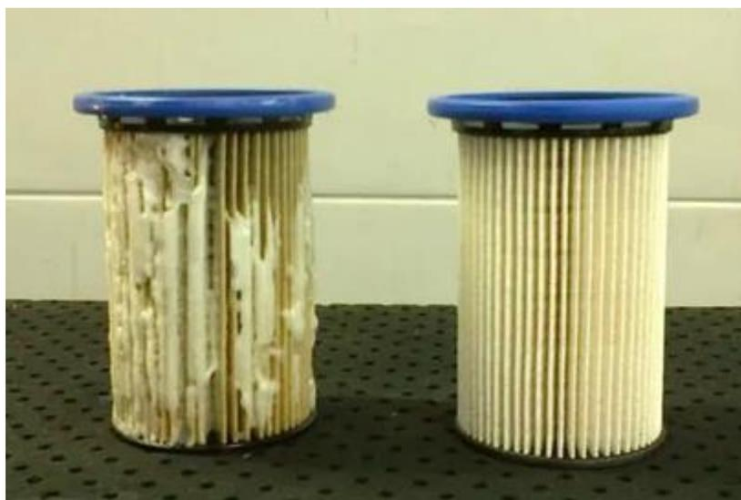
Рисунок 2 - Парафин в топливном фильтре.
