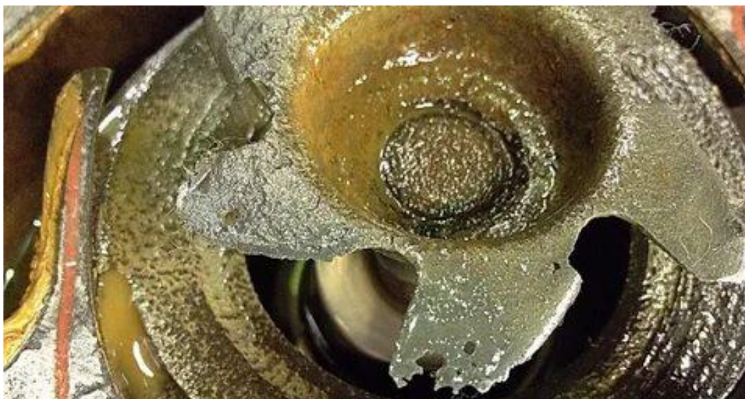
Рисунок 3 – Химический износ водяного насоса автомобиля семейства ВАЗ.
