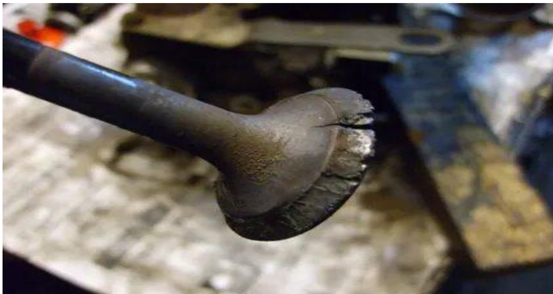
Рисунок 2 - Термический износ выпускного клапана.
