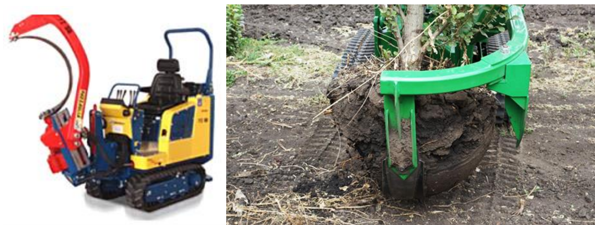
Рисунок 2 – Самоходная машина, с дугообразным ножом, для выкопки растений.
