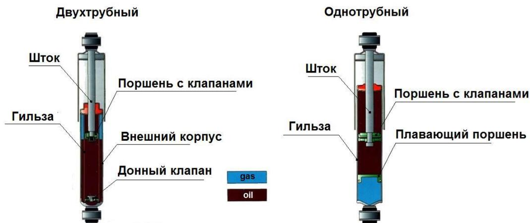
Рисунок 1 - Схема конструкции двухтрубных и однотрубных амортизаторов.
