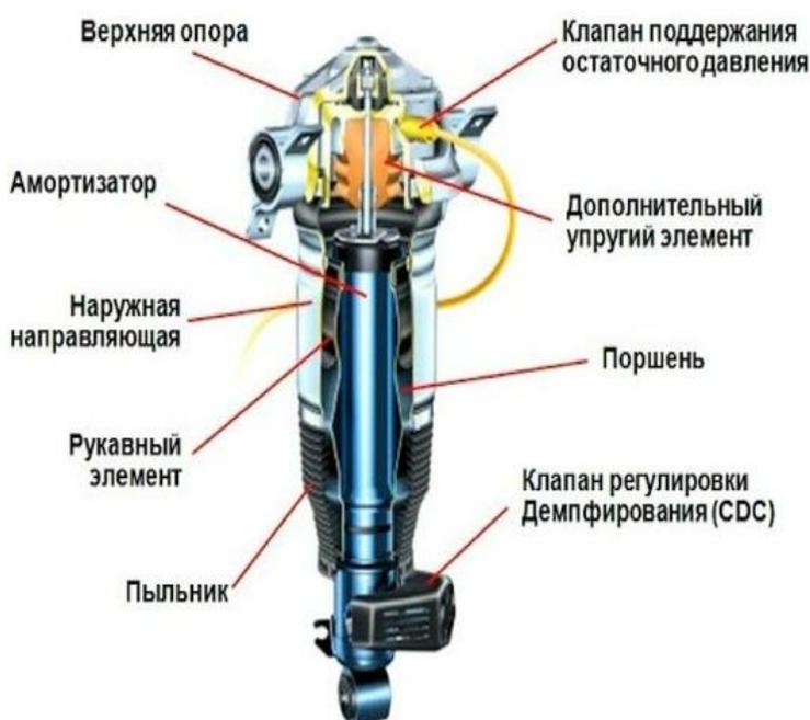
Рисунок 2 – Адаптивный амортизатор с электромагнитным клапаном.
