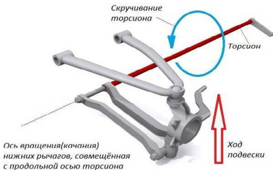
Рисунок 3 – Торсионная подвеска.
