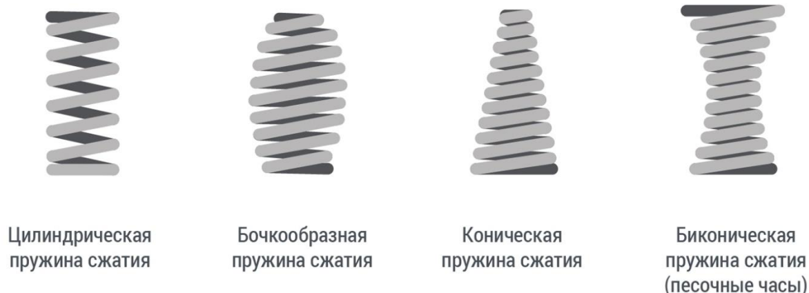
Рисунок 1 – Типы пружины подвески с постоянным шагом намотки.
