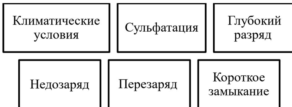
Рисунок 1 – Причины износа аккумулятора.
