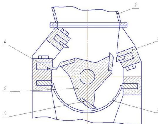
Рисунок 5 – Измельчитель для переработки различного рода сыря.
