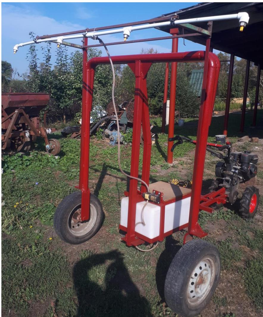
Рисунок 4 - Адаптер-опрыскиватель для мотоблока.
