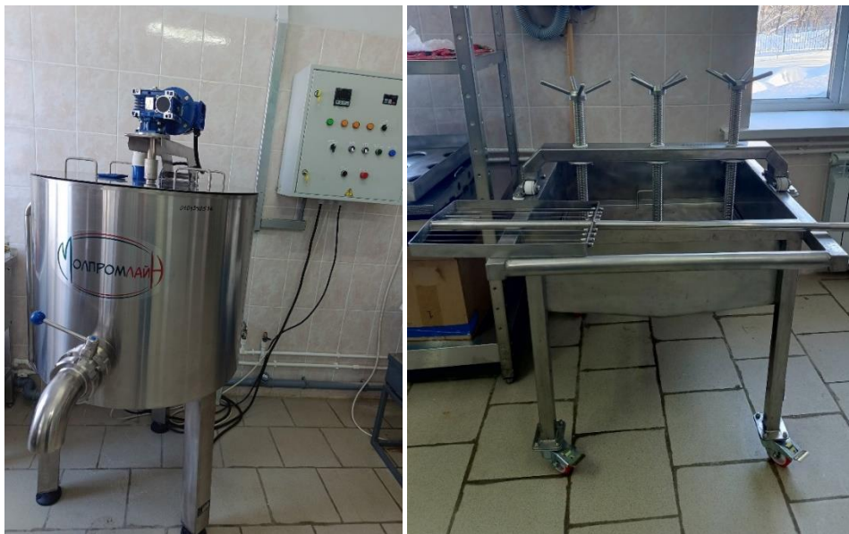
Рисунок 2 – Сыроварочный котел СК-200, сырная пресс-тележка и лира.
