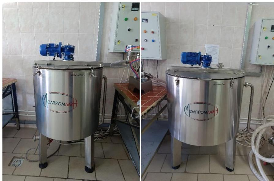
*Рисунок 3 – Ванны длительной пастеризации объемом 100 и 200 л соответственно*
