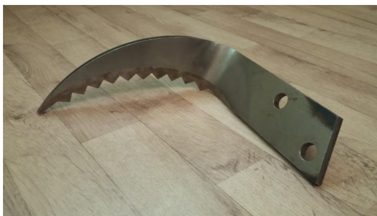
Рисунок 1 – Нож почвообрабатывающей фрезы зубцеобразной формы
