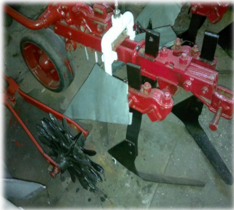
Рисунок 4 – Секция рабочих органов машины для ухода за посевами сахарной свеклы
