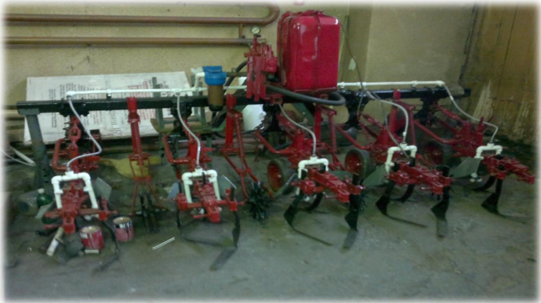
Рисунок 3 – Макетный образец технического средства для ухода за посевами сахарной свеклы
