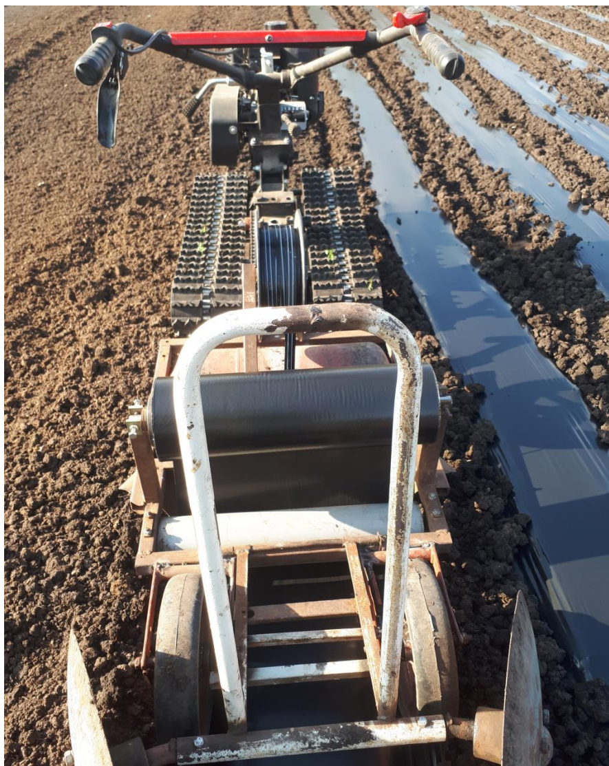
Рисунок 2 - Пленкоукладчик, агрегируемый с мотоблоком
