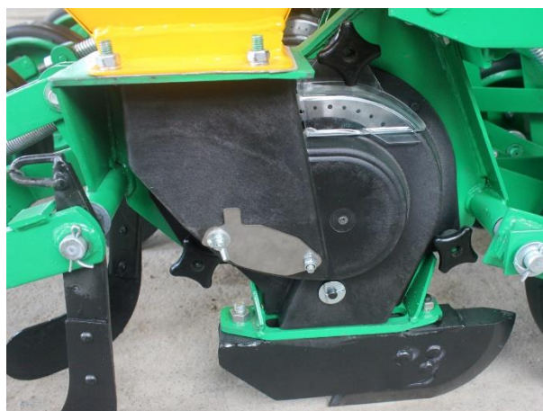
б) Крышка Сеялки МС-8 из пластика 2015 г. по 2023 гг. (заводская)
