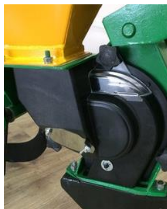
г) Крышка eМС-8 3D печать установленная на опытном образце
