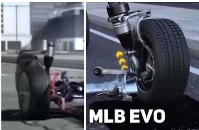
*Рисунок 2 – Электромеханическая часть шасси Audi A8*
