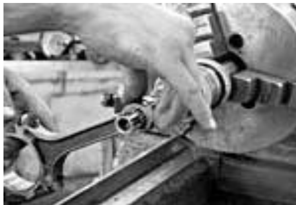
Рисунок 3 – Схема хонингования верхней головки шатуна алмазной головкой
