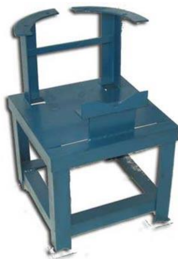
Рисунок 3 - Стенд модели М-407 для разборки-сборки редукторов задних мостов автомобилей МАЗ и КРАЗ
