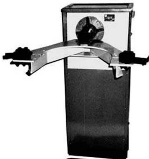
Рисунок 2 - Стенд Р-640 для разборки-сборки редукторов задних мостов автомобилей ЗИЛ и КамАЗ
