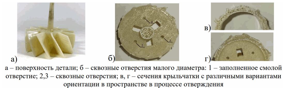
Рисунок 3 – Крыльчатка счетчика воды турбинного типа
