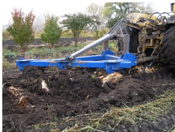
Рисунок 3 – Производственные испытания рыхлителя-вычесывателя РВ
