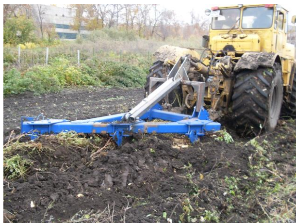
Рисунок 3 – Производственные испытания рыхлителя-вычесывателя РВ
