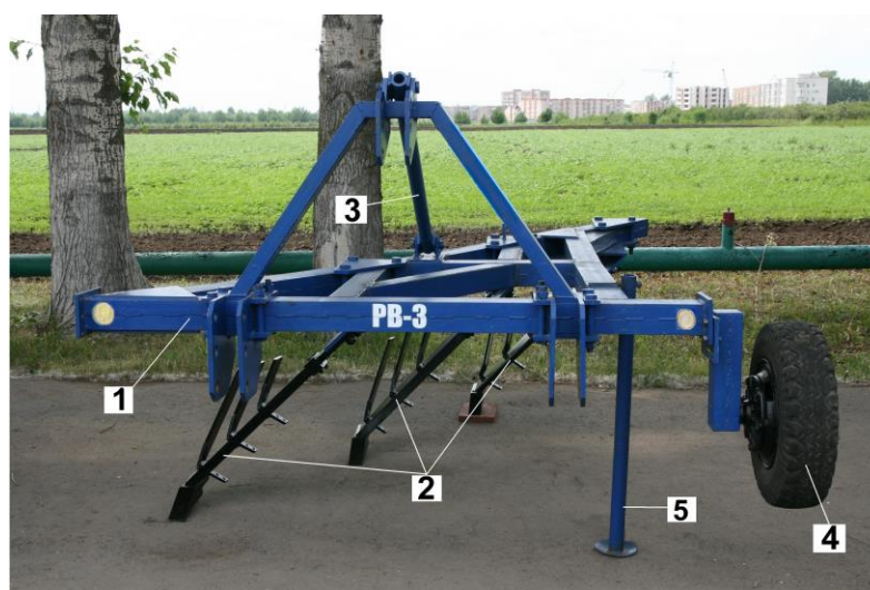
1 – рама; 2 – рабочие органы; 3 – верхняя стяжка; 4 – опорное колесо (левое колесо снято); 5 – опорная стойка
