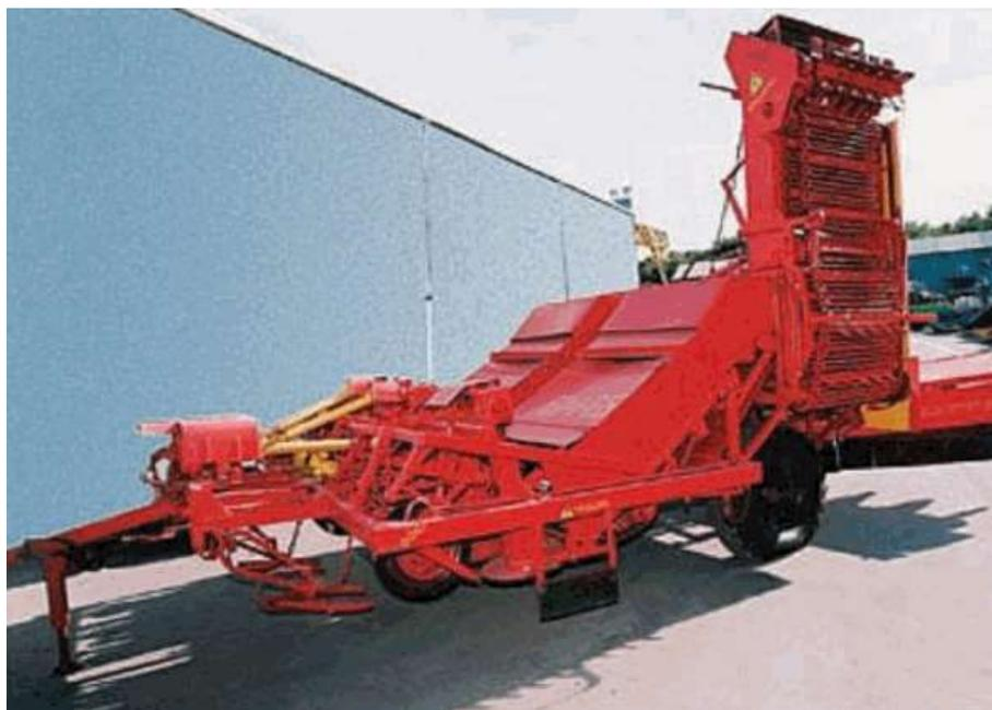
*Рисунок 1 – Устройство для предварительной уборки ботвы БМ-8А*
