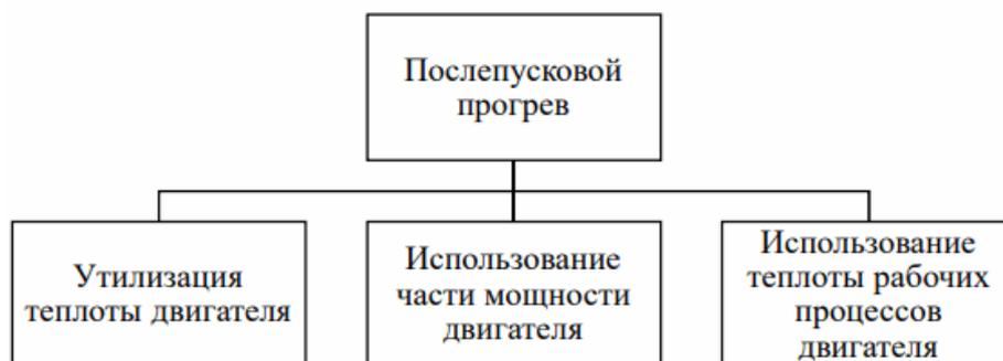
Рисунок 1 – Методы прогрева двигателя внутреннего сгорания вместе с устройствами для прогрева двигателя внутреннего сгорания
