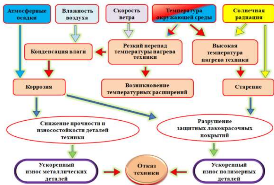
Рисунок 1 – Принципиальная схема того как окружающая среда влияет на характеристики и свойства деталей и узлов сельскохозяйственной техники
