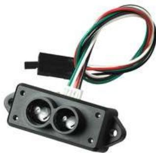
*Рисунок 1 – Лазерный дальномер TFmini Plus Benewake*
