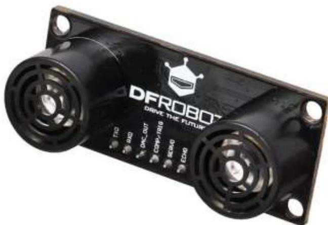
Рисунок 5 – Ультразвуковой дальномер DFRobot URM37
