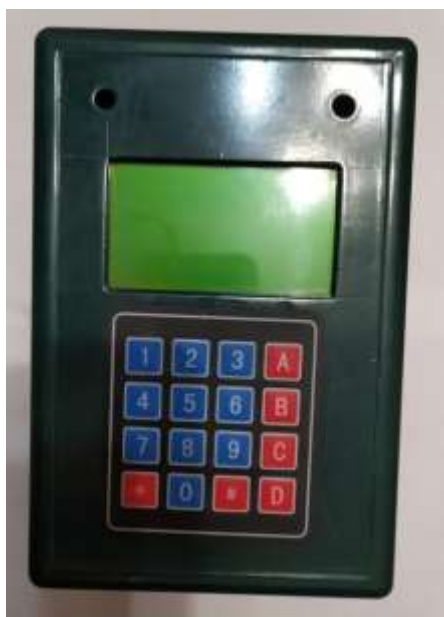
Рисунок 7 - Передняя панель устройства для исследования твердости и плотности почвы
