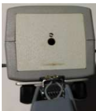
Г). Вид спереди – входная диафрагма и синий излучатель
