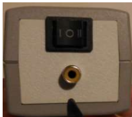
Б) Вид сзади. Переключатель П3, задающий мощность излучения; разъем для подключения внешней кнопки управления
