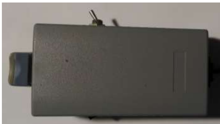
А) Вид сверху. Справа – прижим для листьев; сверху – переключатель П1 зондирующих потоков (красный – синий); снизу - переключатель П2, задающий режим активации излучателей «ручной - автоматический»
