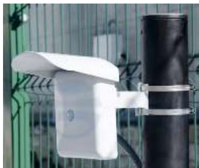
Рисунок 7 - Извещатель охраны объемный радиоволновый ЗЕБРА-30А
