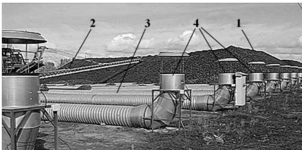
Рисунок 1 – Формирование кагата длительного вентилируемого хранения: 1 – кагат, 2 – буртоукладочная машина, 3 – вентиляционный канал, 4 – вентиляционный агрегат
