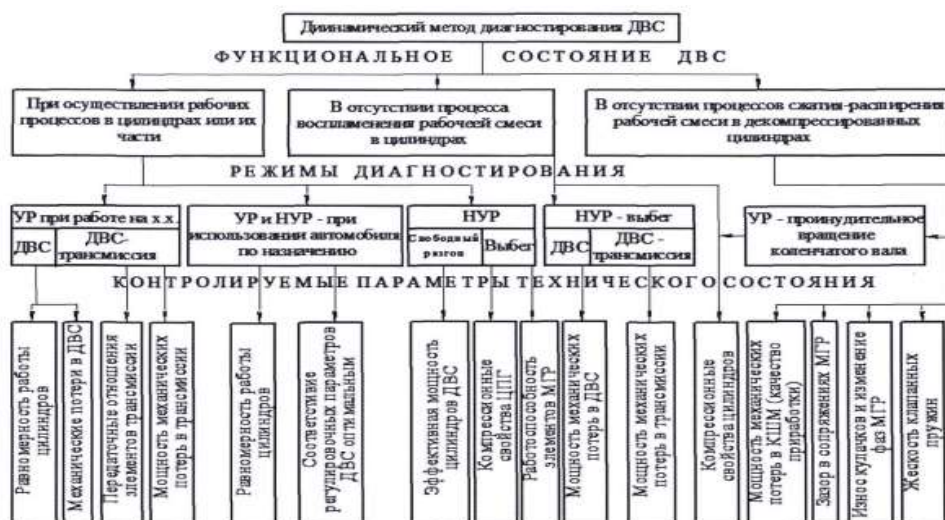
Рисунок 2 – Классификационные признаки, способы и контролируемые параметры при диагностировании элементов ДВС динамическим методом
