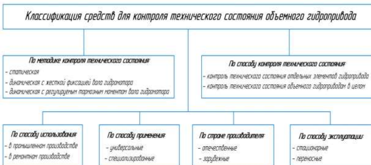
Рисунок 1 – Классификация методов и средств контроля технического состояния гидрообъемных приводов
