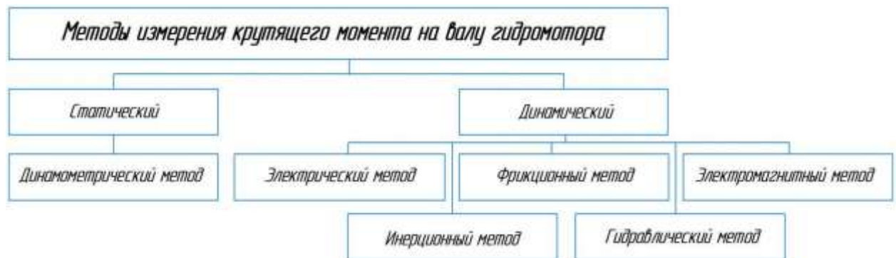
Рисунок 2 – Классификация методов измерения крутящего момента на валу испытуемого гидромотора.
