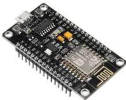
Рисунок 3 – NodeMCU на основе модуля ESP8266
