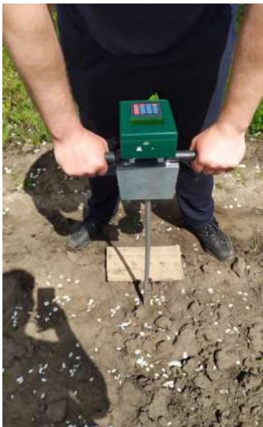
Рисунок 1 – Разработанный цифровой пенетромтр в процессе проведения измерений
