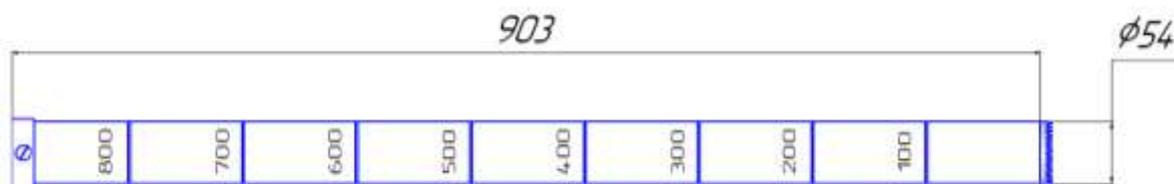
Рисунок 3 – Пробоотборник для взятия образцов грунта.
