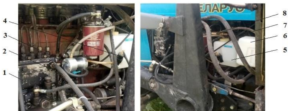
1 – топливный насос высокого давления, 2, 7 – топливные шланги, 3 – роторно-пульсационный аппарат, 4 – электрический насос, 5 – смесительная ёмкость для водно-дизельной смеси, 6 – ёмкость для воды, 8 – дозатор-смеситель
