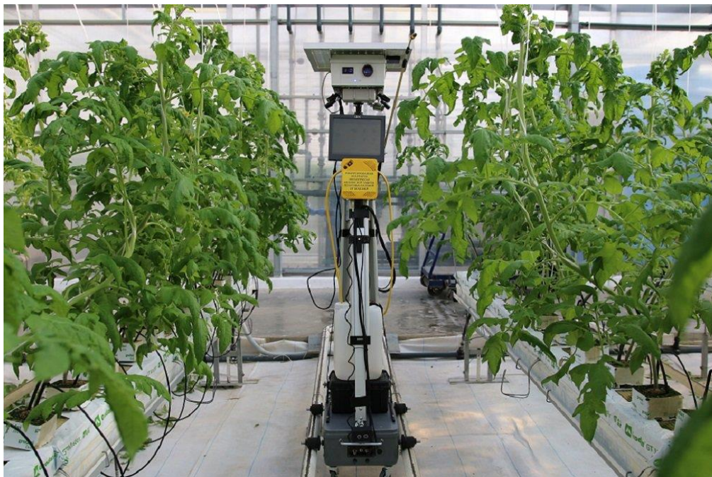
Рисунок 5 - Роботизированная платформа экологически безопасной защиты тепличных растений от болезней. Мичуринский ГАУ, Мичуринск (из [5]).
