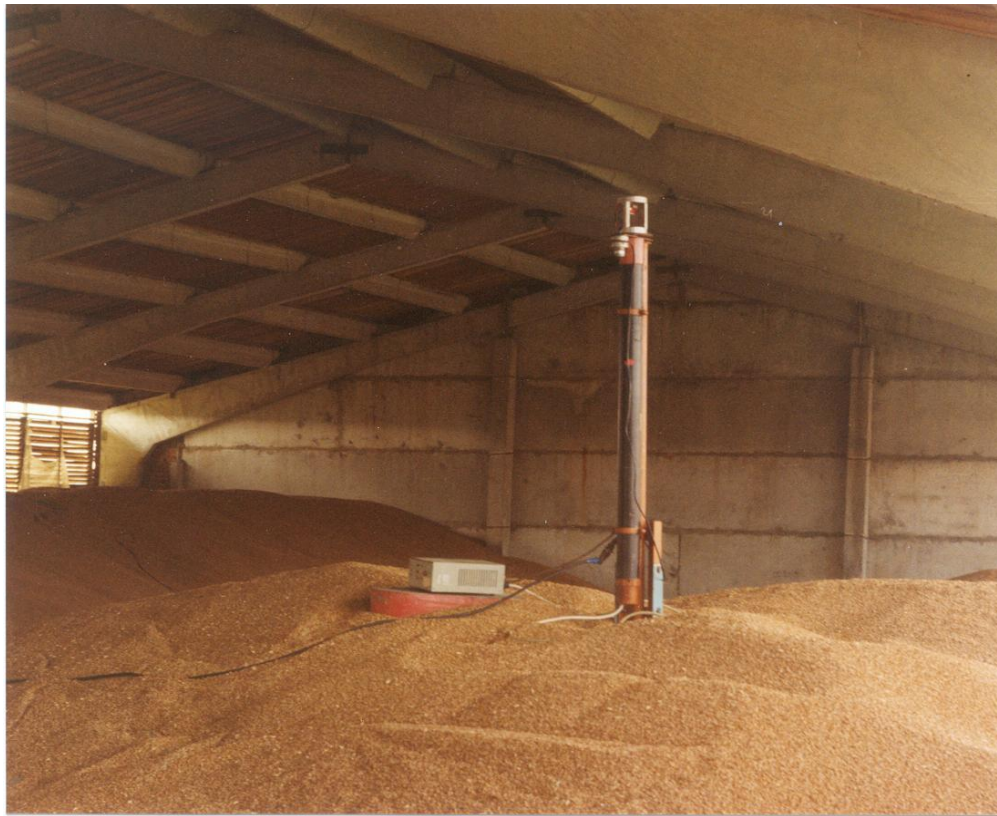
Рисунок 4 - Установка для лазерной обработки зерна, разработчик ООО "НПФ "Биолазер" (из [4]).
