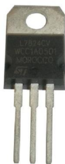
Рисунок 1 – Интегральная схема стабилизатор напряжения L7824
