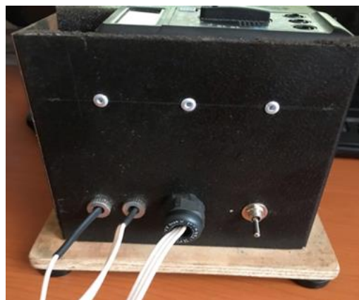
Рисунок 4 - Структурная схема и вид прибора для измерения электромагнитных свойств сельскохозяйственных продуктов.
