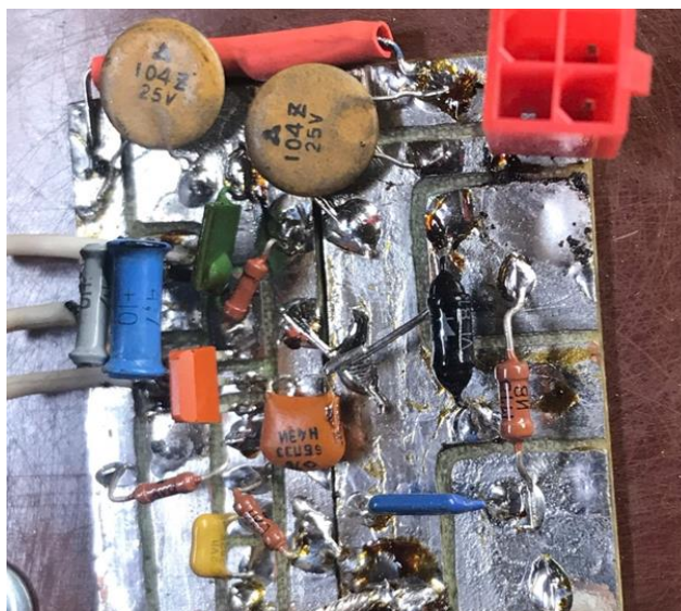
Рисунок 5 - Принципиальная схема резонансного усилителя и его внешний вид
