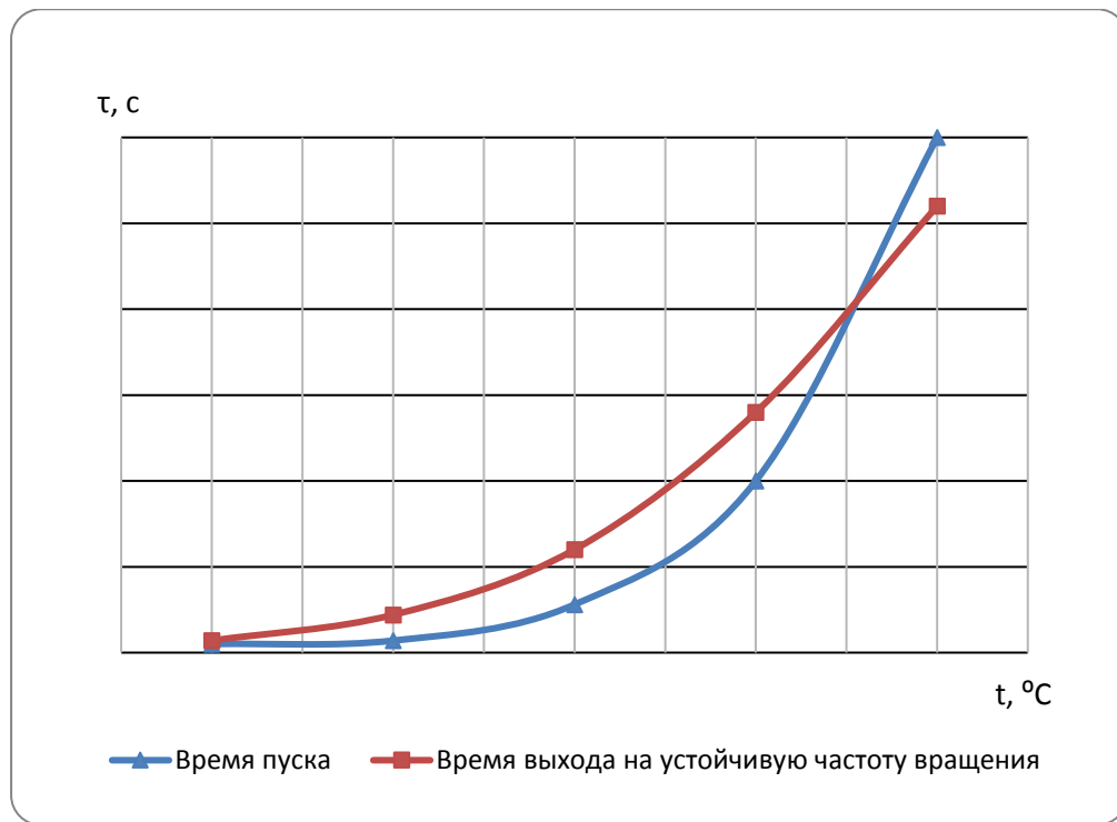
Рисунок 1 - Зависимость времени пуска дизельного двигателя от температуры окружающего воздуха
