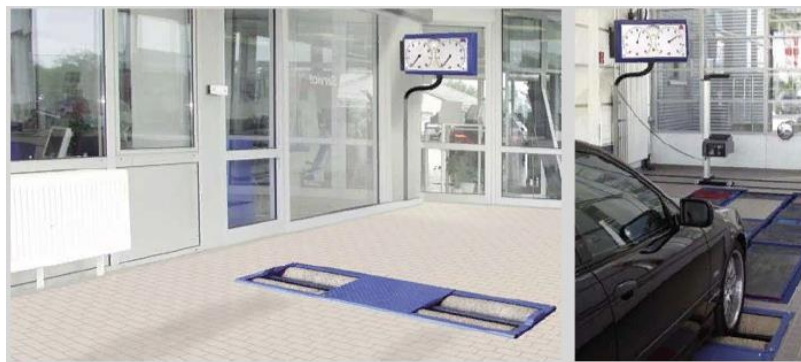
Рисунок 4 – Силовой роликовый тормозной стенд МВТ 2100 фирмы МАНА
