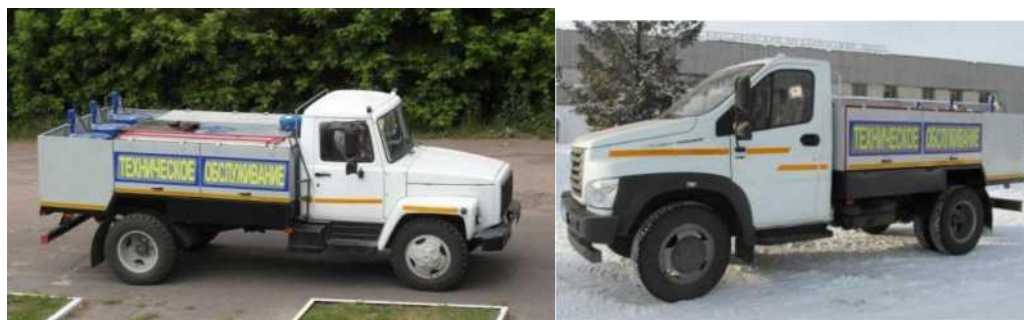
Рисунок 2 - Агрегат технического обслуживания АТО-9994: а) на базе ГАЗ-3307; б) на базе ГАЗ «NEXT»
