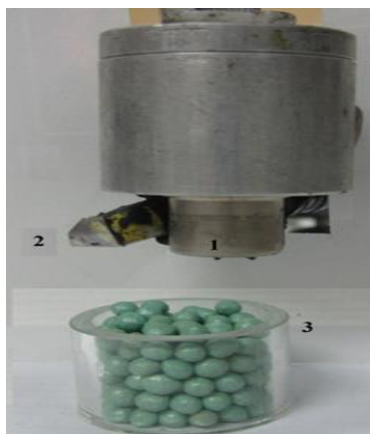
Рисунок 1 – Фотоэлемент стенда для измерения отражения потока излучения от дражированных семян: 1- излучающий диод DL; 2 – фотоприемник DP; 3 – кювета с семенами
