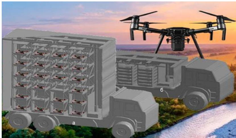
Рисунок 1 - Ремонтно-диагностический комплекс для обслуживания ЛЭП в сложных условиях в рабочем (а) и транспортном положении (б), в формате 3D
