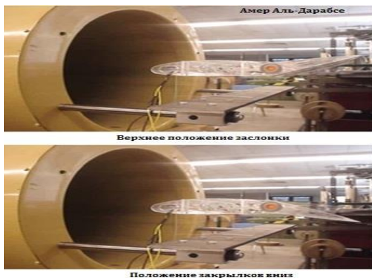
Рис. 10. Испытание системы приведения в действие закрылков при скорости аэродинамической трубы 21,3 м / с
