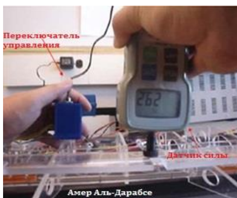
Рис. 9. Измерение силы срабатывания закрылка
