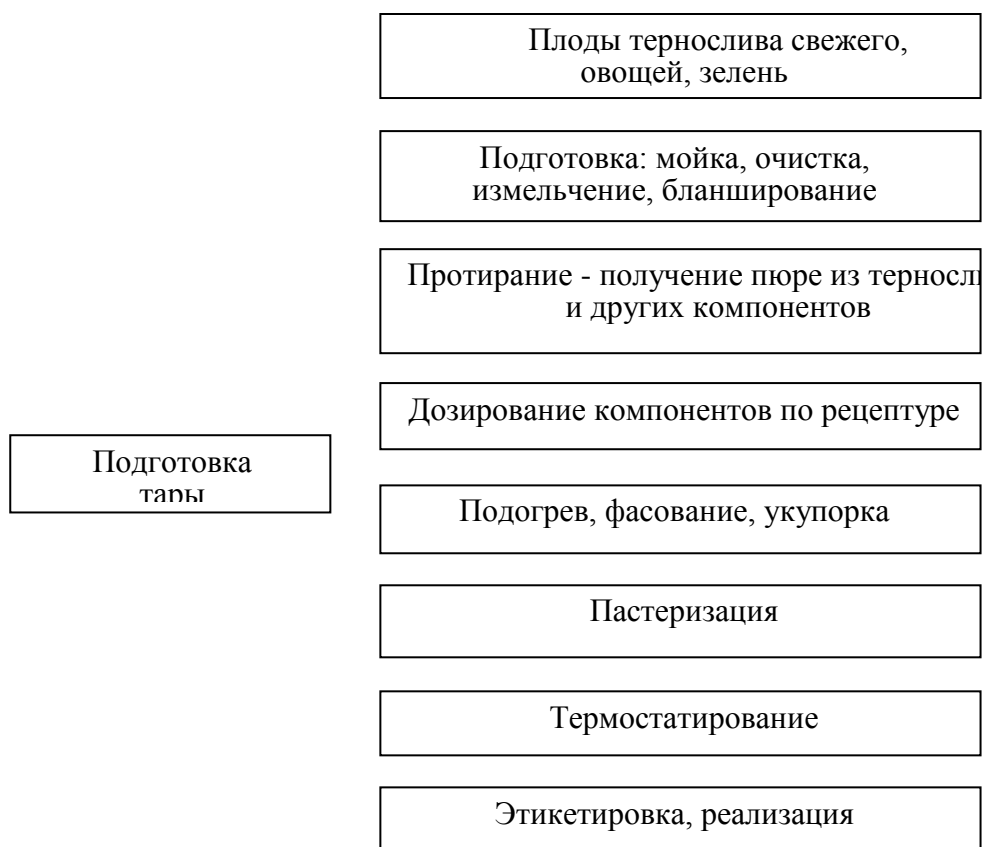
Рисунок 1 - Схема производства соуса из плодов тернослива
