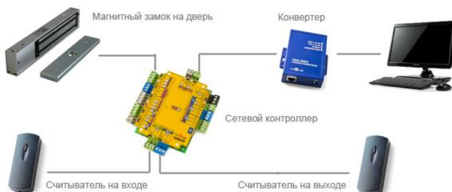
Рисунок 2 – Схема подключения сетевой СКУД
