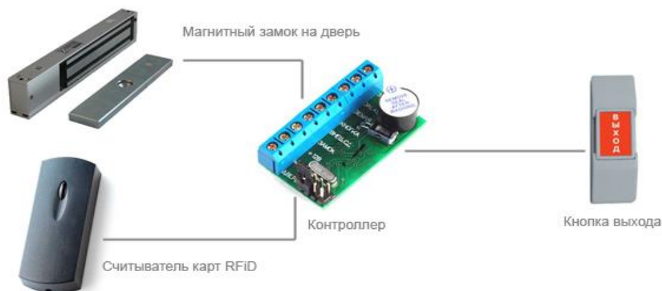
Рисунок 1 – Схема подключения автономной СКУД
