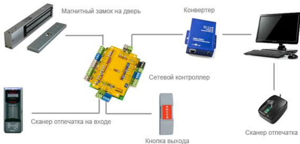
Рисунок 3 – Схема подключения биометрической (по отпечатку пальца) СКУД
