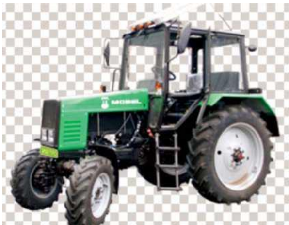
Рисунок 1 - Электротрактор на базе трактора «Беларус 920»
