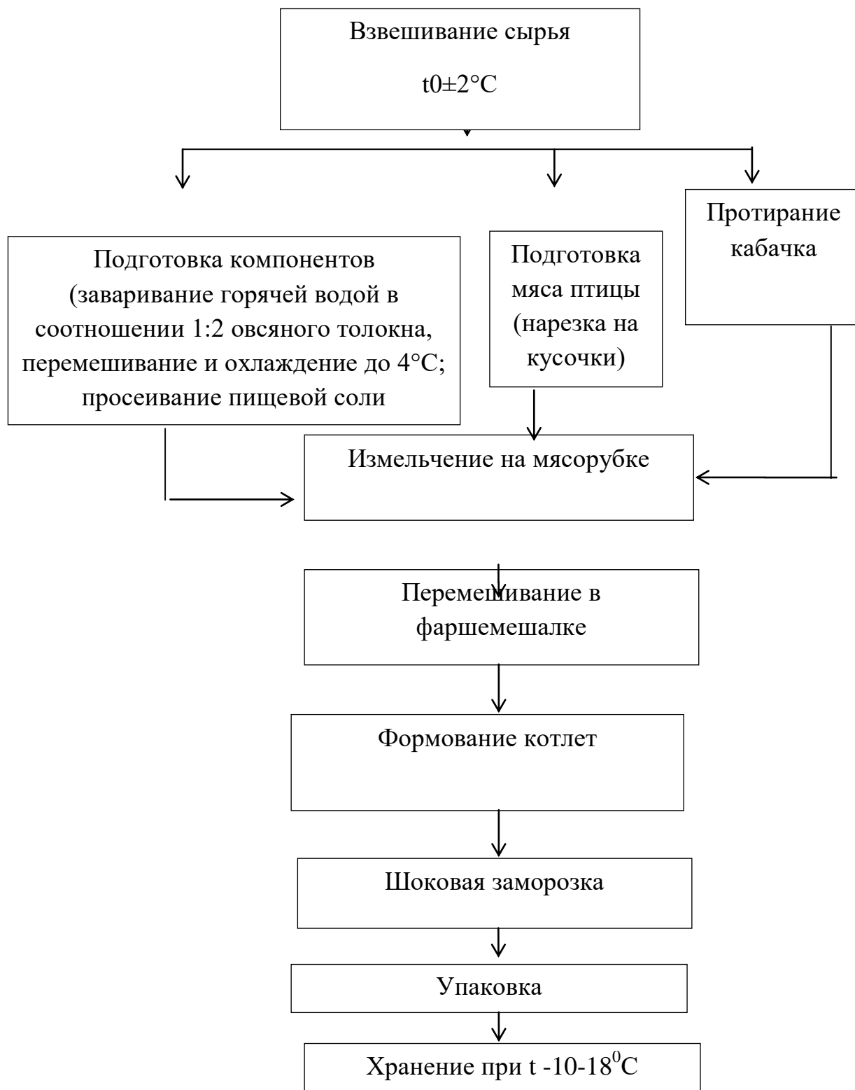
Рисунок 1. Технологическая схема производства котлет рубленых из мяса птицы с растительным сырьем для профилактического питания, включая онкологические и кардиологические. А производство данных полуфабрикатов позволит восполнить дефицит важных нутриентов.
