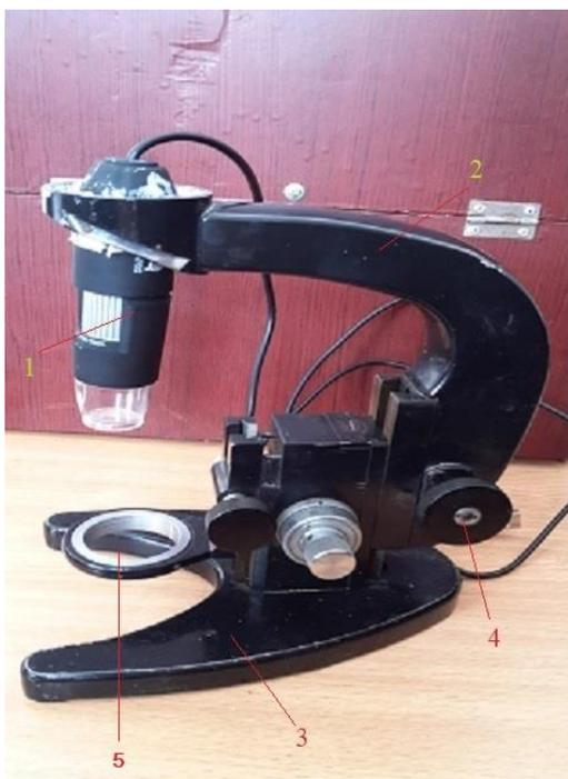
Рисунок 3. Стенд на базе микроскопа МБИ-1
