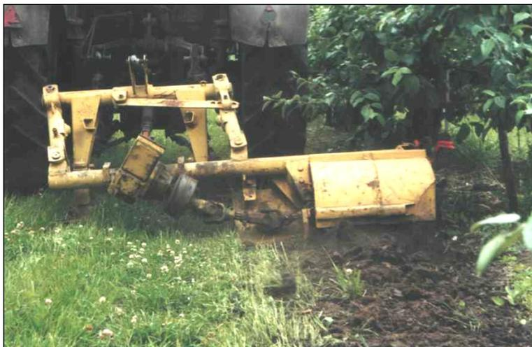
Рисунок 1 - Обработка приствольной полосы сада фрезой ФЯ-0,5
