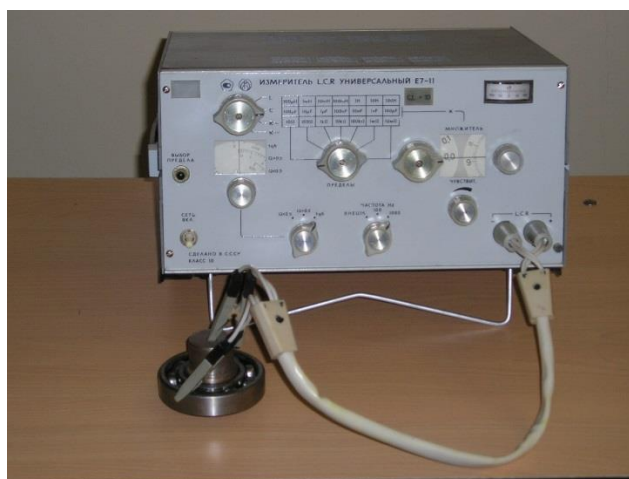
Рисунок 2 – Исследование процесса полимеризации герметика АН-112 и композиции на его основе прибором E7-11
